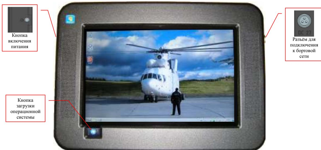
Рис. 2 Аппаратно-программный модуль «Vibro3»
