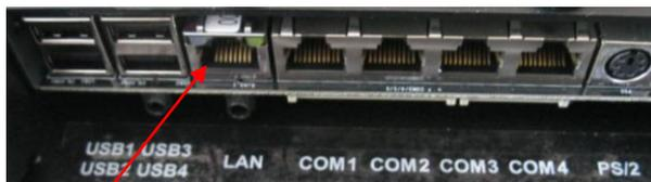
Рис. 2 Розетка для подключения кабеля RJ-45 от БКУ
